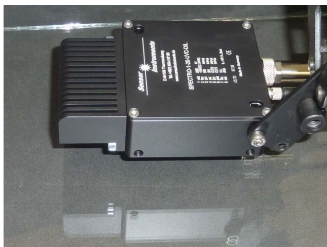
Sensor SPECTRO-1-20-UVC-DIL, direcionado para o lado de estanho de um vidro flotado
