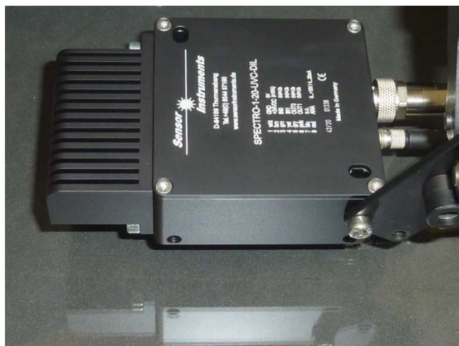
Sistema de sensores SPECTRO-1-20-UVC-DIL, direcionado para o lado do ar de um vidro flotado a uma distância de 20 mm
